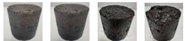
Рис. 14. ЩПС. КР. Ц (II) із залізистих кварцитів, укріплених 6 % цементу
