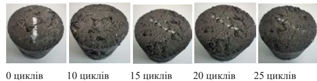
Рис. 3. ЩПС.КР.Ц(I) із залістистих кварцитів, укріплених 4 % цементу
