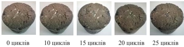
Рис. 8. ЩПС. Кр. Ц (I) із гранітних сумішей, укріплених 4 % цементу
