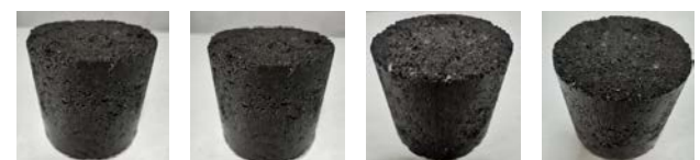
Рис. 15. ЩПС. КР. Ц (II) із залізистих кварцитів, укріплених 8 % цементу
